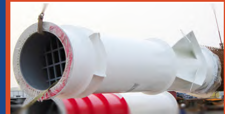
Gia công chế tạo kết cấu ống khói
